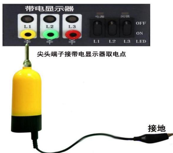
提示：由于带电显示器的主要作用是显示开关柜是否带电，并非标准的核相点，且不同厂家、不同时期、不同标准的带电显示器会产生不同的测量结果。
