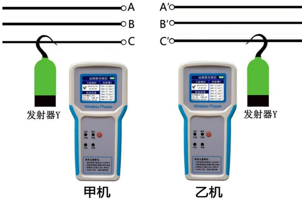
先将两台接收主机开机，切换到远程核相模式，在室外有GPS信号的地方完成授时，直至语音播报发射器无信号。再分别将Y发射器接触所测带电线路，此时两台接收主机每5(10)秒记录一组数据，No1到No6分别为每分钟的0s、5s(10s)、10s(20s)、15s(30s)、20s(40s)、25s(50s)的数据，对比甲乙两机同一编号的数据即可判断同异相。显示界面如下：
