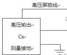
注：（小图）仪器面板简图只标了“高压屏蔽线”，现实操作时也可以如大图所示，高压芯线与高压屏蔽线可以夹在一起测试
