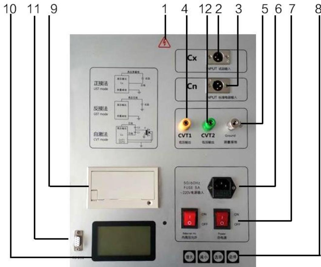
1 高压输出端 2、CX 试品输入 3、CN 标准电容输入 4 CVT1 5、测量接地 6、电源输入
