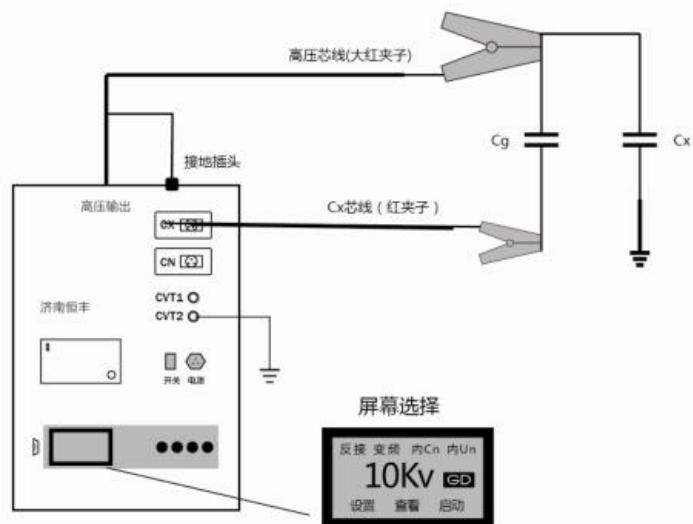
光标在“反接”位置按“启停”键，屏幕右侧显示 **GD**，启动反接线低压屏蔽功能。再次按“启停”键，恢复正常反接线。需要屏蔽的电容  $C_g$  的低压端子不能承受高电压，不能用常规反接线的 10kV 高压屏蔽，因此只能使用反接线低压屏蔽。
